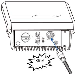
Abb. 13: Anschluss des AC-Kabels an das SP-Gerät
