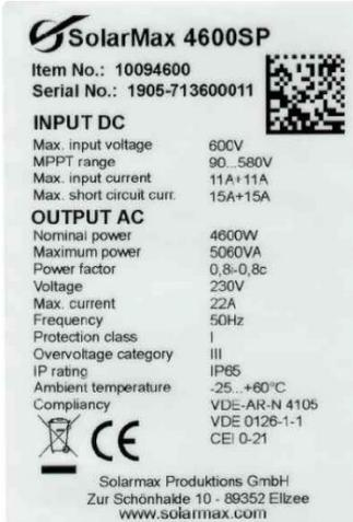
Abb. 1: Typenschild des SolarMax 4600SP
