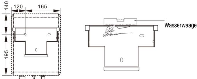
Abb. 7: Befestigen der Montageplatte an der Wand
