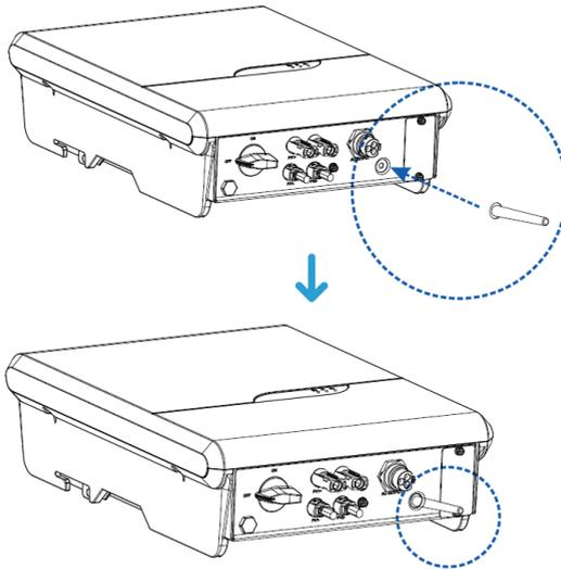
Abb. 21: Anschluss der WLAN-Antenne
