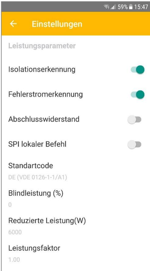
Abb. 27: MaxLink Wechselrichter-Einstellungen
