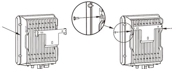
Abb. 8: Befestigen des SP-Gerätes an der Montageplatte
