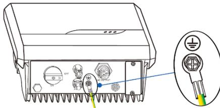
Abb. 11: Anschluss des externen Schutzleiters
