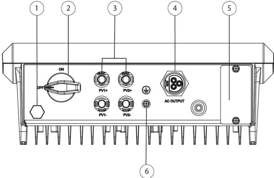
Abb. 4: Anschlüsse an der Unterseite des SP-Gerätes
