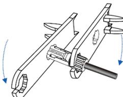
Abb. 18: Fixieren des Kabels mit der Kabelverschraubung
